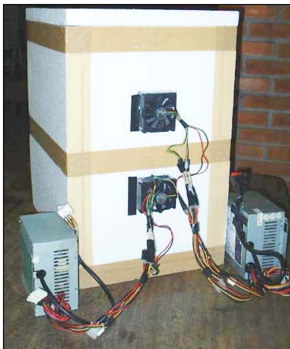
Figura 11: Sistema de Refrigeração montado
